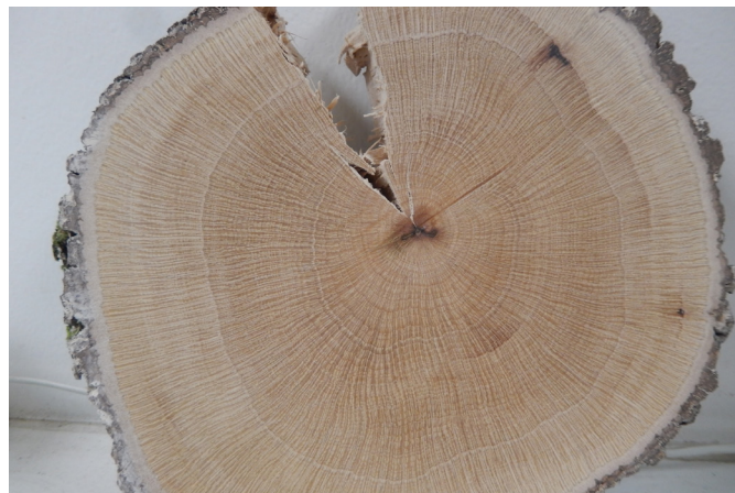
La lecture des cernes du chêne vert est très délicate : les rondelles récoltées ont dû être poncées puis analysées à la loupe binoculaire
