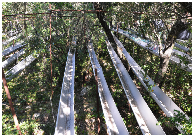
Le système d'exclusion de 30 % des eaux de pluie sur la parcelle expérimentale de Puéchabon
