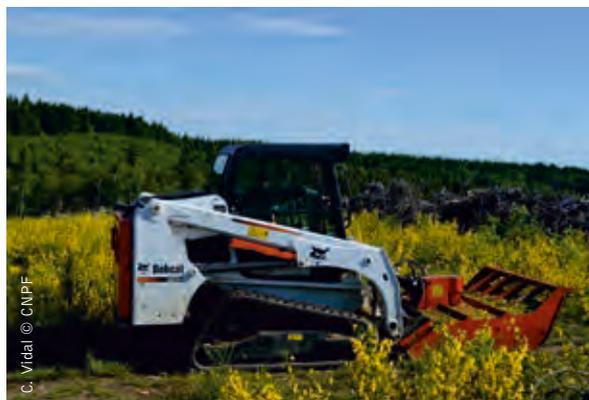
Bobcat équipé d'un broyeur à axe vertical Grenier Franco.
