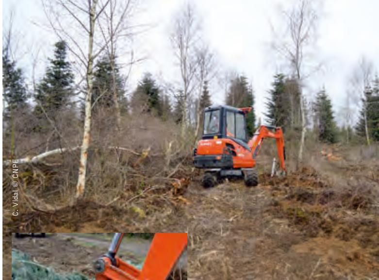
Sous-soleur multifonction® créant des potets de 1 m<sup>2</sup> tous les 3 m. Nettoyage par broyage en bande tout les 6 m.
