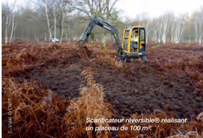
Scarificateur réversible® réalisant un plateau de 100 m<sup>2</sup>.
