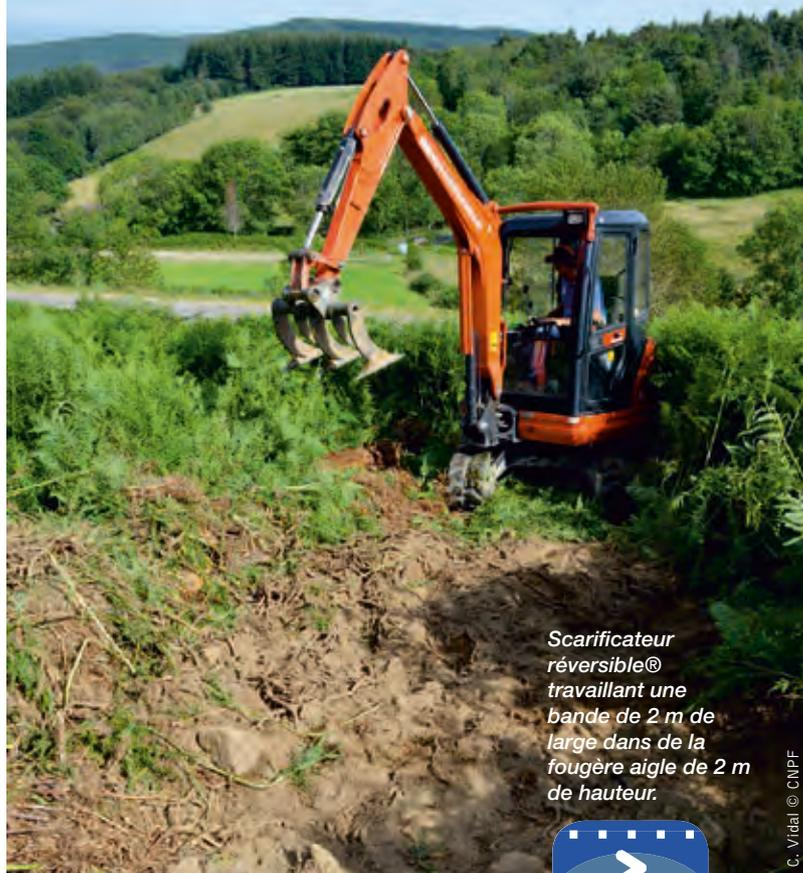
Scarificateur réversible<sup>3</sup> travaillant une bande de 2 m de large dans de la fougère aigle de 2 m de hauteur.
