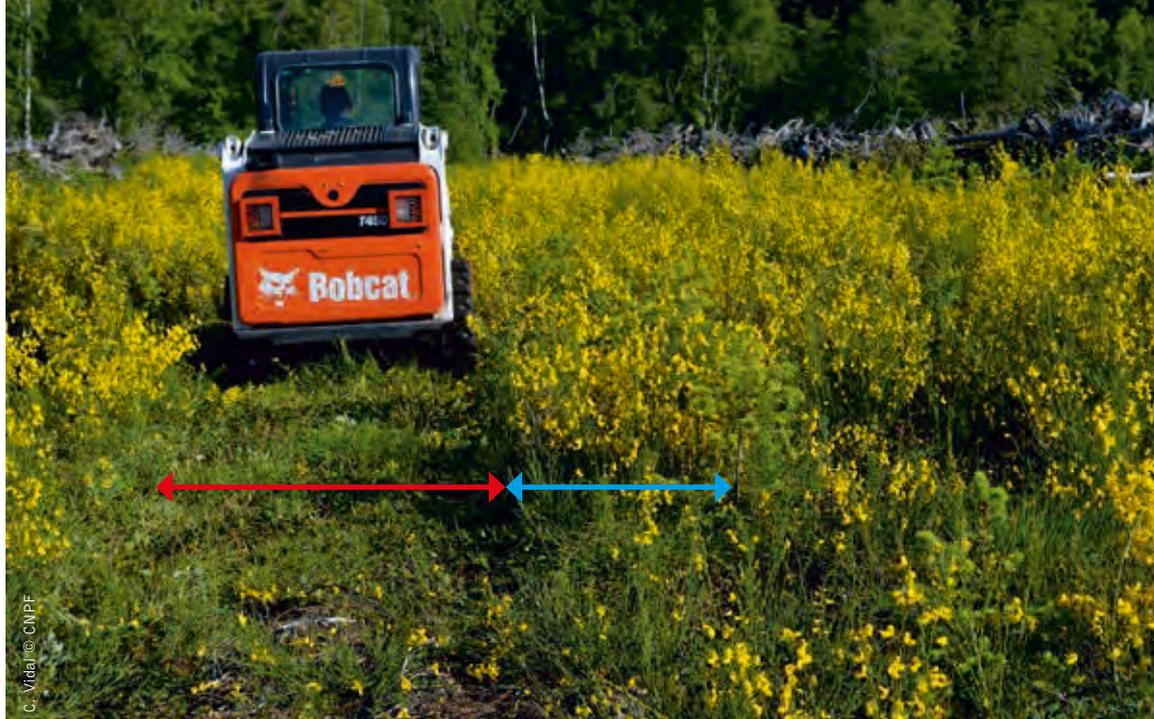
Broyage d'une bande de 1,4 m (largeur de la double flèche rouge) préservant un ourlet de végétation (largeur de la double flèche bleue) entre le passage et le plant (3,2 m entre lignes).
