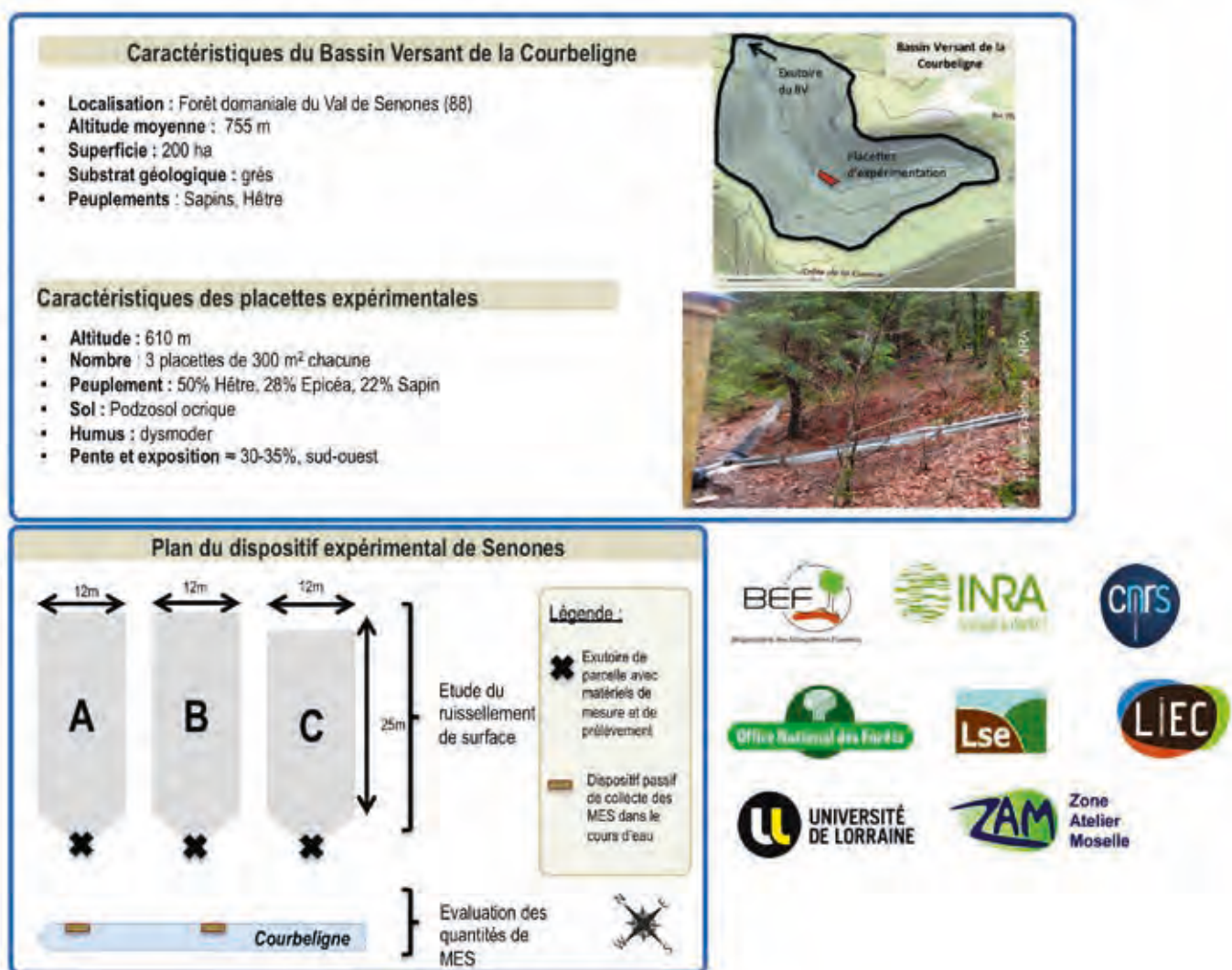
Figure 1 - Dispositif expérimental sur l'érosion dans les Vosges
