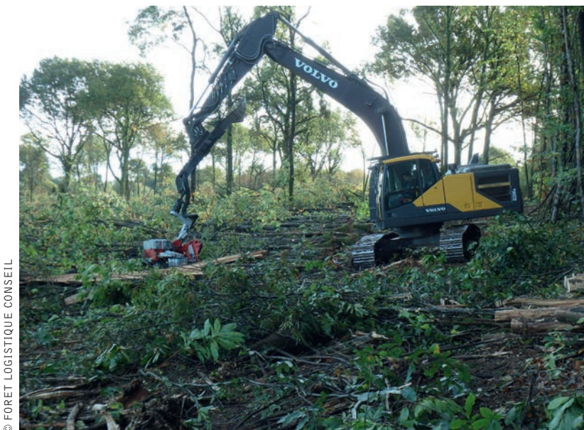
Machine de bûcheronnage valorisant des châtaigniers abattus à l'aide d'une abatteuse-groupeuse (feller-buncher).
