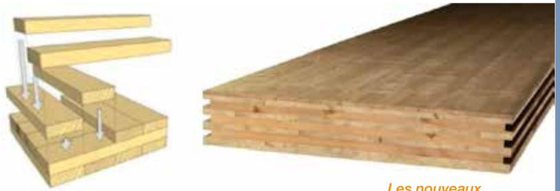
Les nouveaux principes constructifs, le lamellé croisé (*cross laminated timber* ou CLT)
