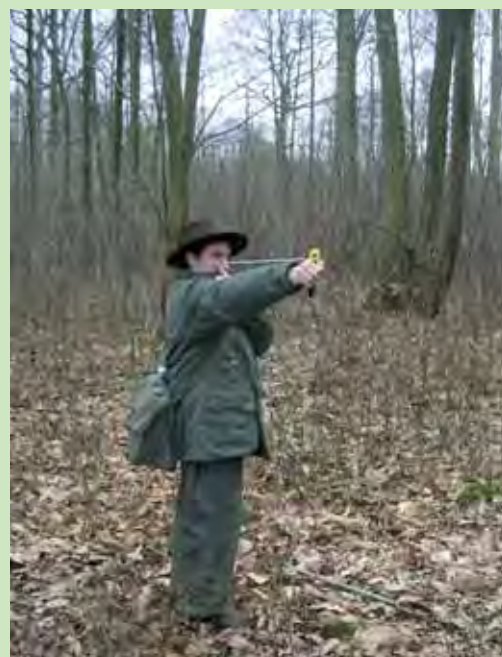
Mesure de surface terrière dans un mélange chêne-châtaignier.
