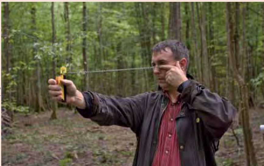
Mesure de la surface terrière pour identifier le type de peuplement.
