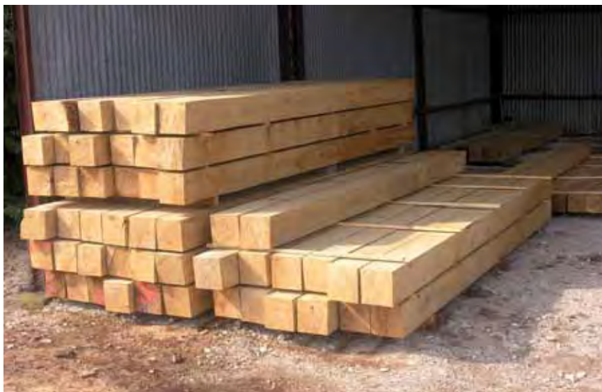
Poutres conditionnées pour le séchage.
