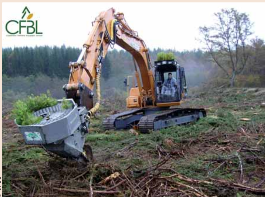
Mécanisation des reboisements avec le « Bracke Planter » mis au point par CFBL.
