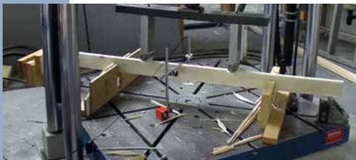
Début de l'essai de flexion 4 points pour l'évaluation des performances mécaniques des sciages.
