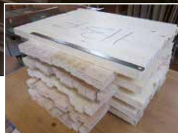
Figure 1 : Placages secs de 5,25 mm d'épaisseur, presse, éprouvettes pour les tests mécaniques.
