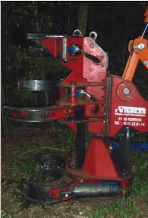
Tête d'abattage type « sécateur » montée sur pelle mécanique
