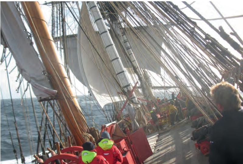
*L'Hermione sous une forte gîte de 36 °, roulant bord sur bord, pour un angle de chavirement calculé à 56 °.*
