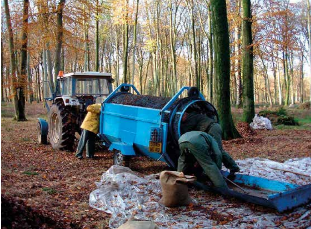
Une trieuse est acheminée dans le peuplement de hêtre pour séparer les fâines des feuilles tombées au sol.
