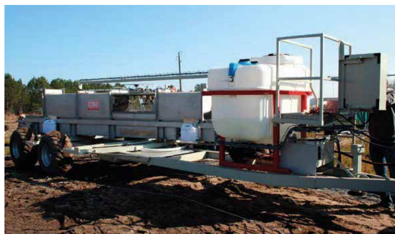
Chaîne de traitement au Merit™Forest de plants en godet mis au point par la pépinière Planfor (40).
