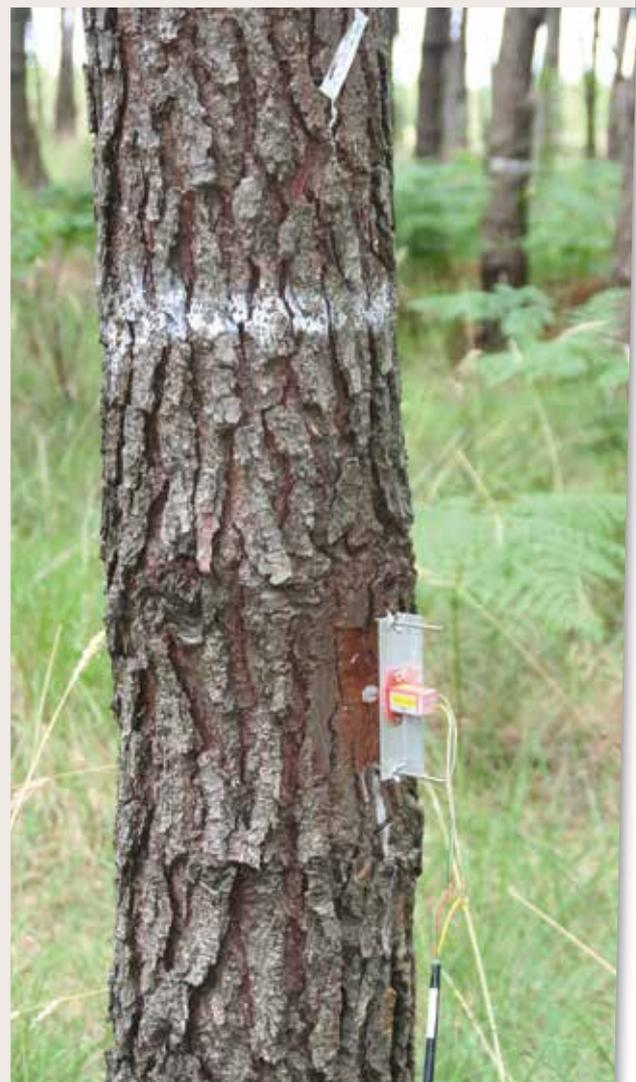
Dendromètre électronique enregistrant les variations temporelles de dimensions du tronc à 1 mètre de hauteur.
