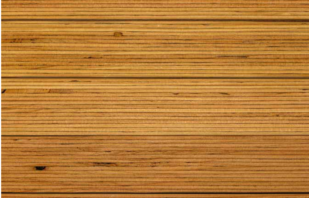
Pile de panneaux de LVL de Douglas vus de côté.
