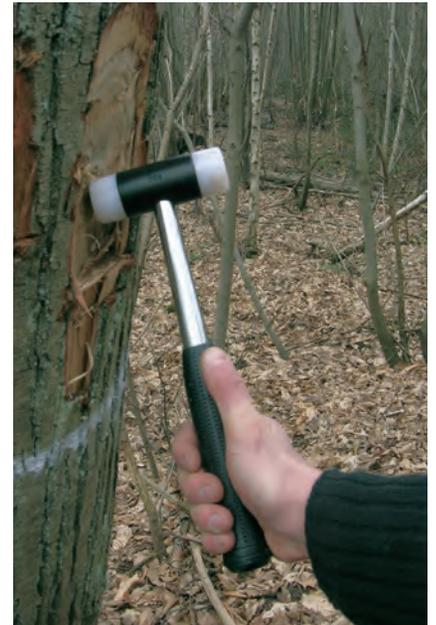
Photo 4 : Test à l'oreille sur le flachis.
