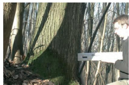
Photo 3 : Mise en œuvre du résistographe.
