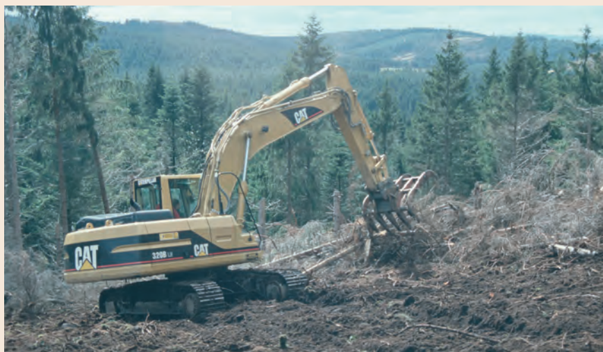
Andainage à la pelle équipée d'un râteau andaineur (Becker), Meymac.
