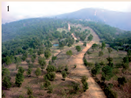
Exemple de coupure de combustible destinée à limiter les surfaces parcourues par les incendies dans le Massif des Maures.
