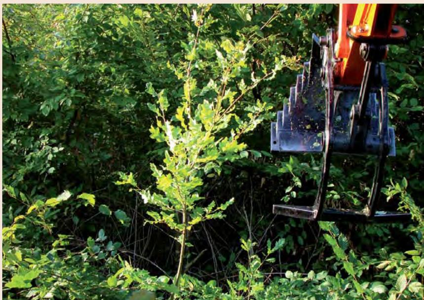
Le sécateur® particulièrement adapté au débroussaillage.
