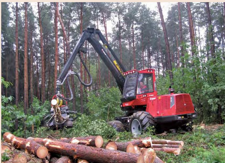
*Machine de bûcheronnage Valmet à cabine pivotante.*
