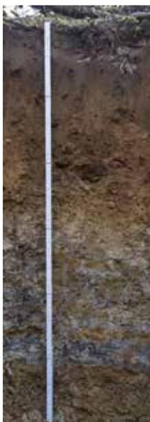
*Fosse pédologique réalisée sur le Plateau lorrain par la Société Forestière. Cette fosse profonde (1,2 m) permet de noter rapidement les textures et structures, la présence d'un plancher argileux sous les horizons sableux à 60 cm, la profondeur d'enracinement et de quantifier les taches d'hydromorphie.*
