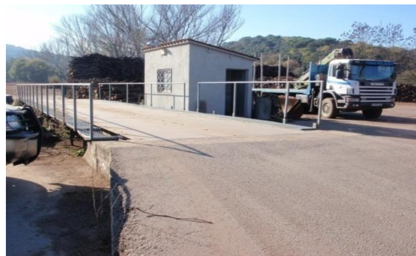
Balance pour la pesée de camions ou autres véhicules chargés de bois
