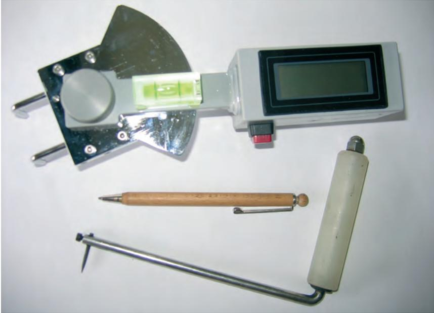
*Spirolyte pour la mesure de l'angle du fil entre 2 aiguilles plantées dans le fil du bois.*
