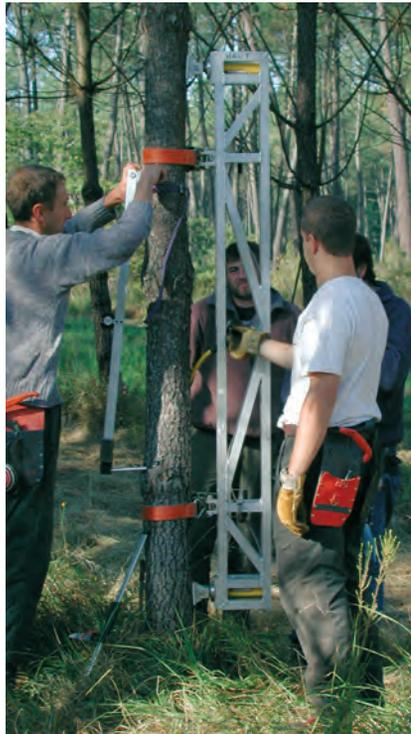
*Rigidimètre pour l'estimation de la résistance en flexion de l'arbre: appareil mis au point à l'INRA Orléans.*
