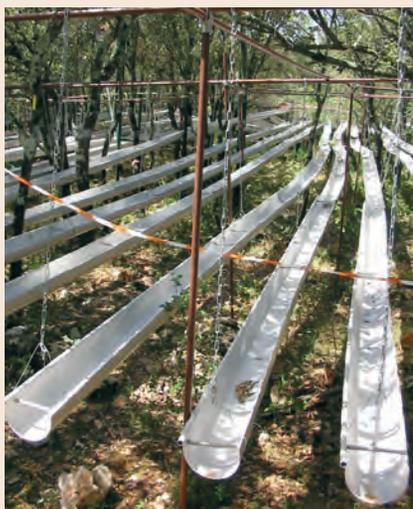
Dispositif d'exclusion de 30 % des pluies installé en 2003.
