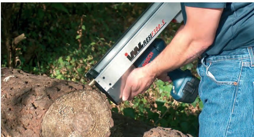
Résistographe pour l'estimation de la densité du bois.
