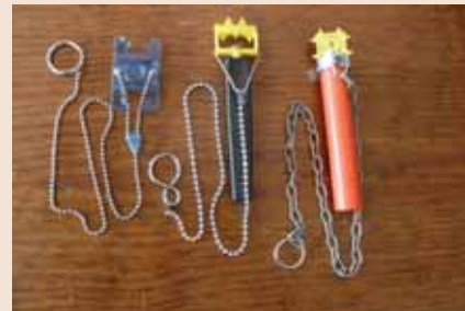
Différents modèles de relascopes.
