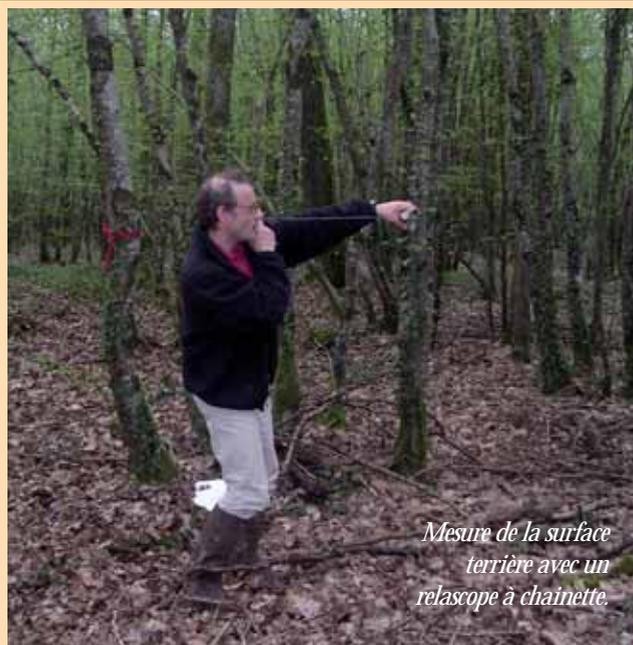
Mesure de la surface terrière avec un relascope à chaînette.
