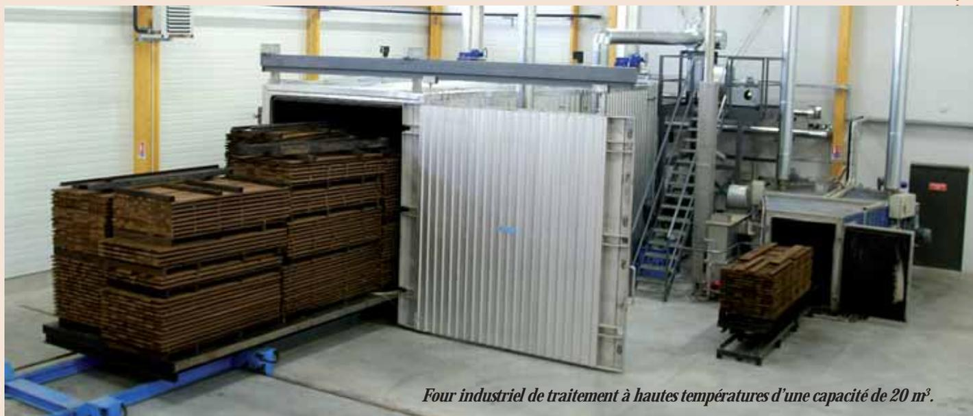
Four industriel de traitement à hautes températures d'une capacité de 20 m<sup>3</sup>.
