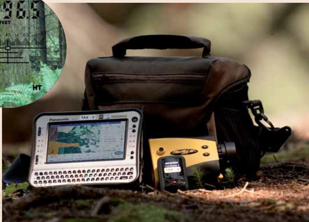
*La technologie Field-Map. L'ordinateur de terrain, le laser télémètre (incluant télémètre, boussole, inclinomètre permettant de mesurer les hauteurs des arbres à distance variée et les diamètres éloignés) et le GPS permettent l'estimation de la valeur du peuplement ainsi que la cartographie détaillée des peuplements.*
