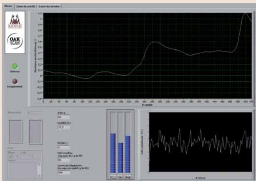
Logiciel d'interface du capteur OakScan® en cours de mesure montrant un spectre proche infrarouge et la prédiction pour les trois valeurs chimiques donnée par les modèles d'étalonnage.
