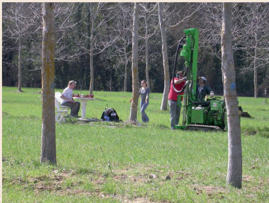
Figure 9 : carottages dans une parcelles de noyers et céréales pour estimer la longueur totale de racines fines des noyers (mars 2009).
