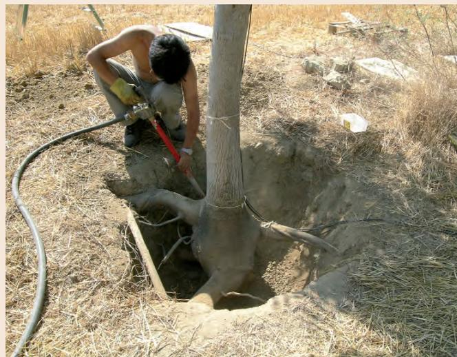
Figure 5 : dégagement d'une fosse de 1 m<sup>3</sup> au pied d'un arbre avec un couteau à air, afin d'installer les capteurs de flux de sève sur les racines.
