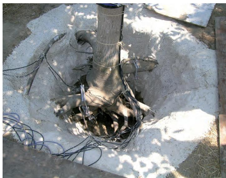
Figure 7 : architecture racinaire du noyer hybride : de nombreux pivots secondaires de développent sous les racines horizontales ou obliques (Atger et Sabatier, 2003).
