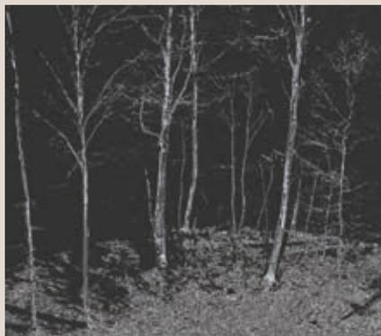
Filtrage du bruit (réalisé dans le logiciel fourni avec le scanner).
