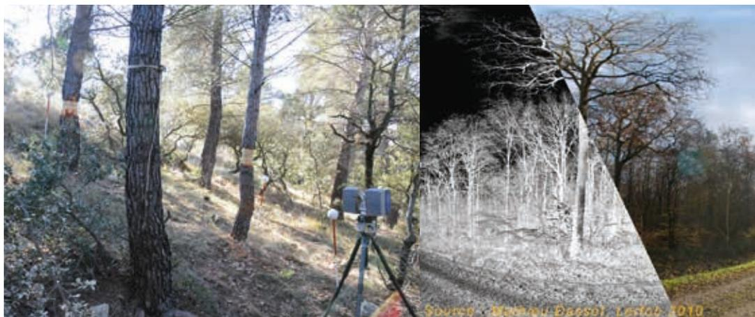
Parmi les nouveaux outils, le laser terrestre : photo de la prise de scans en forêt de Pélicier à gauche et l'exemple d'un scan en forêt de Champenoux à droite.
