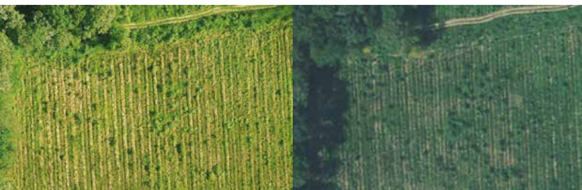
Comparaison de l'orthophoto 3 cm (issue de la mission drone, à gauche) et de celle de l'IGN à une résolution de 50 cm (à droite).
