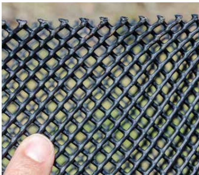
*L'efficacité de la Climatic Agro contre les dégâts de la faune s'explique par la grande rigidité du manchon, liée à sa structure réticulaire particulière (losanges de 5 x 6 mm), l'épaisseur de ses brins (Ø 2 mm) et son grammage élevé (732 g/m<sup>2</sup>) (Lot).*
