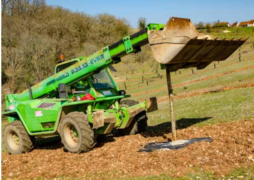
*Il est facile et rapide d'enfoncer profondément un piquet robuste en bois, en se servant du chargeur frontal d'un tracteur ou d'un élévateur télescopique agricole (Lot).*
