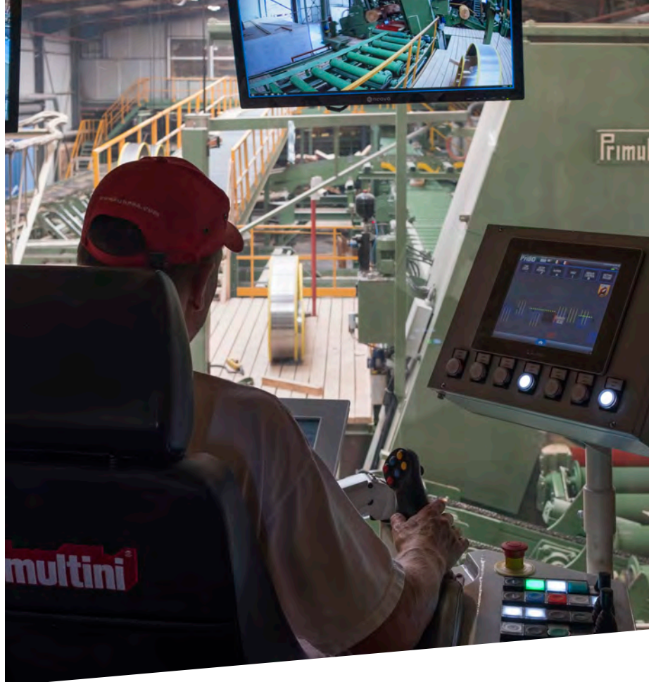
La scie de tête, un poste essentiel, au départ de toute la transformation.
