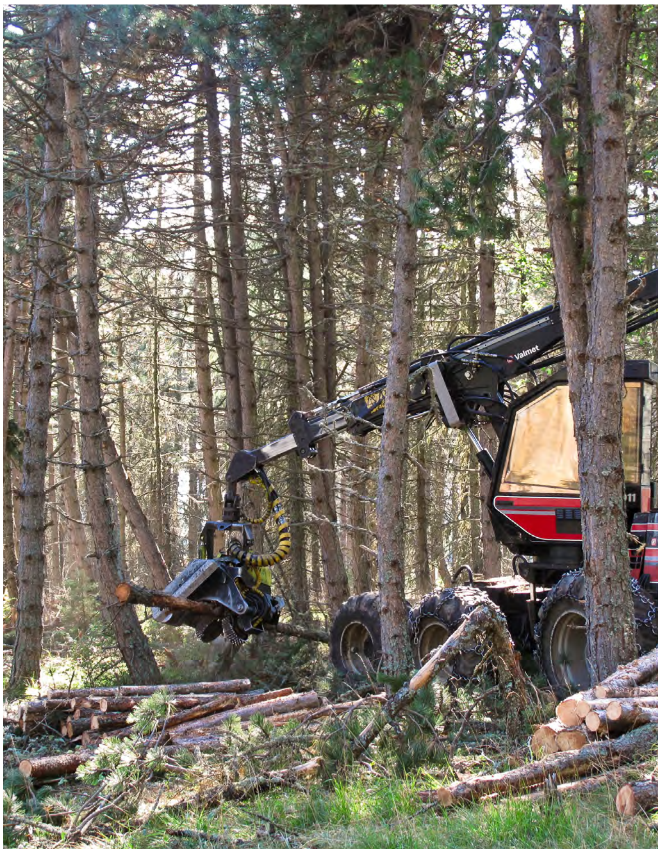
Une abatteuse forestière dans un peuplement de pin.
