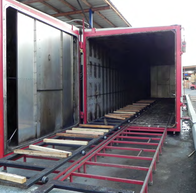
Les incontournables séchoirs, alimentés en énergie par la combustion des déchets de scierie. Jean-Paul Gayot @ CNPF
