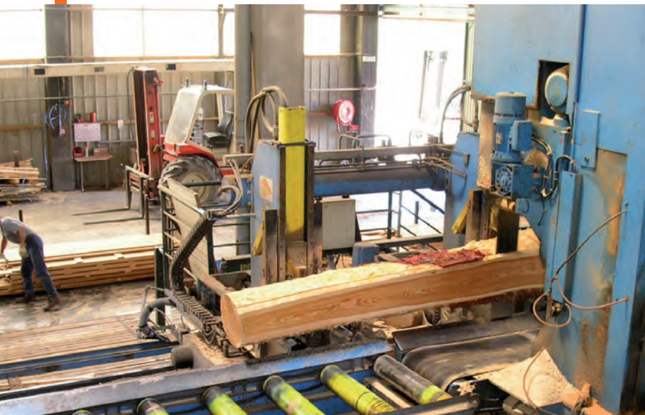
Scie à ruban découpant une planche après avoir enlevé la dosse.
