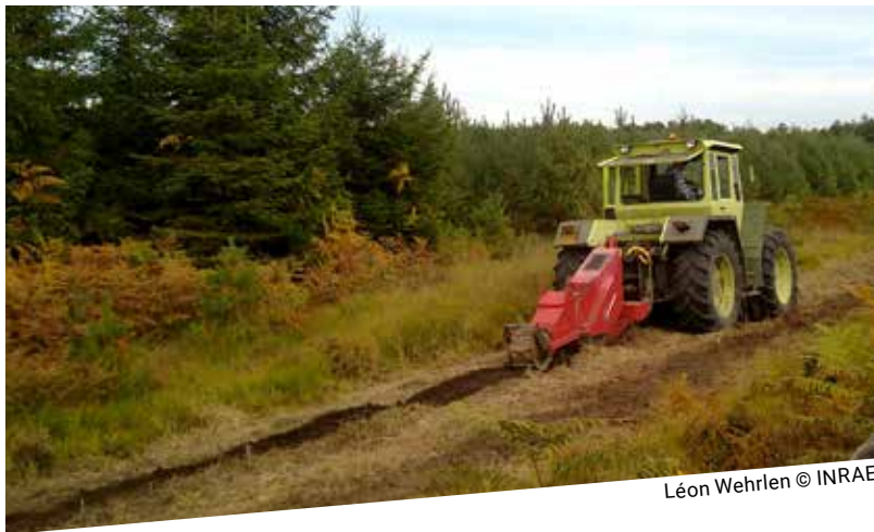
Figure 1 : Préparateur de sol tracté AHWI® PSF1000 Le rouleau suiveur visible à l'arrière de l'outil est un module optionnel.
