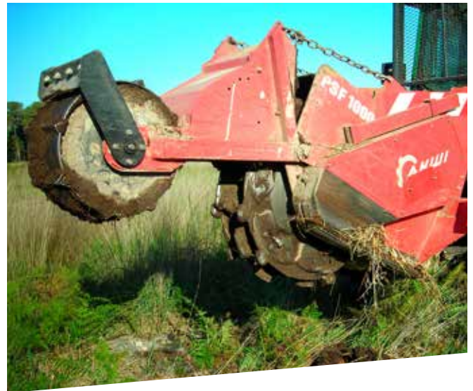
Figure 2 : Détails du préparateur de sol tracté AHWI® PSF1000, avec axe rotatif horizontal muni de marteaux fixes et rouleau suiveur.
