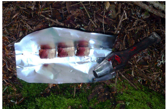
Prélèvement sur un sapin de 3 échantillons de cambium stockés dans une feuille d'aluminium
