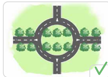
Lors de l'aménagement d'un carrefour, les anciens arbres d'alignements sont intégrés dans la partie centrale du rond-point
