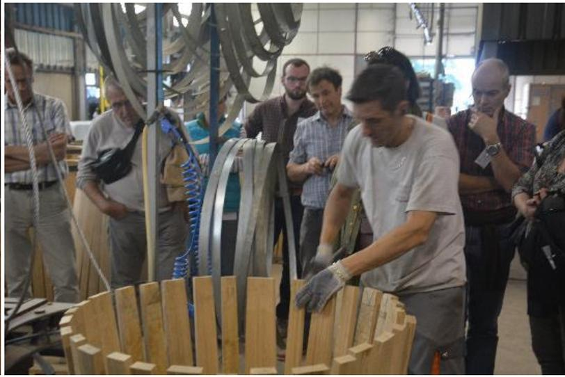
*L'assemblage des douelles, il faut forcer un peu (taper) pour positionner la dernière douelle.*
