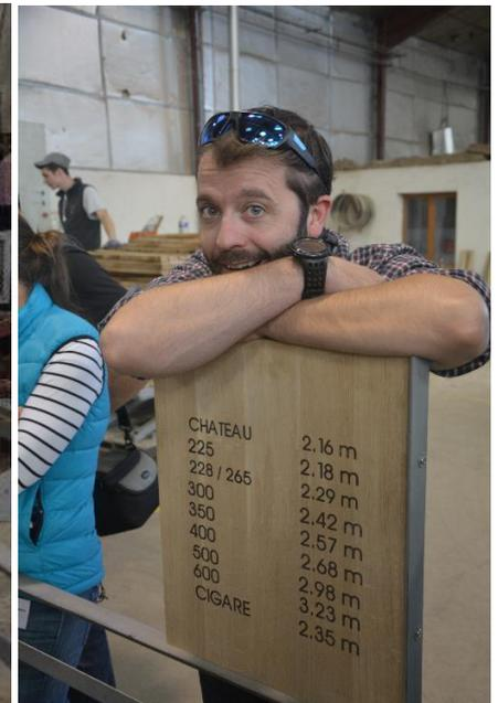
Cette « table » permet de choisir les douelles et de les positionner jusqu'à réaliser la barrique désirée « à plat ». Il faut entre 30 et 32 douelles pour faire un fût. Avec 1 m<sup>3</sup> de douelles, on fabrique 10 fûts. Gaël est appuyé sur le référentiel qui donne la longueur des douelles à « aligner » (nombre de droite), en fonction de la contenance de la barrique à fabriquer (nombre de gauche). Au centre, Philippe Grillot, chef d'entreprise passionné et passionnant en pleine explication.
