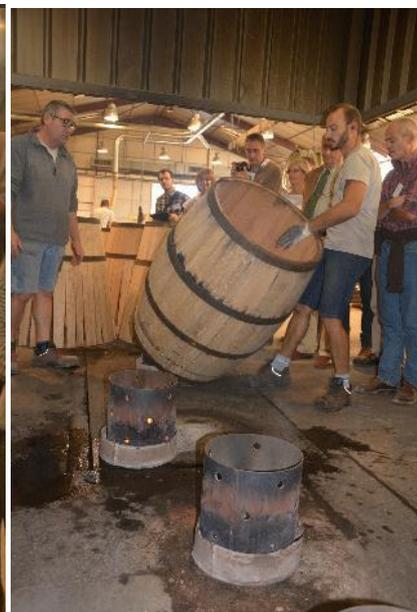
*La chauffe, tout un art ou l'expérience et le respect de la matière parle ! On cuit l'intérieur du tonneau pour assouplir les fibres du chêne. C'est une opération délicate qui va donner un goût plus ou moins prononcé au tonneau, et aura une incidence sur l'élevage du vin et son caractère boisé.*
