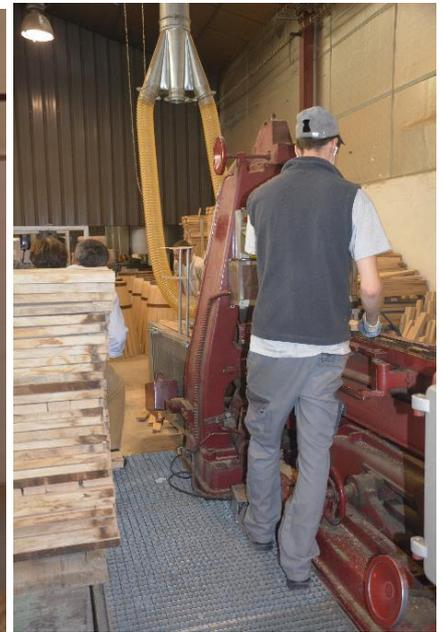
A gauche, machine qui met les douelles aux dimensions. A droite, la « doleuse », machine qui évide les bords en fonction de la largeur pour que les douelles soient jointives.
