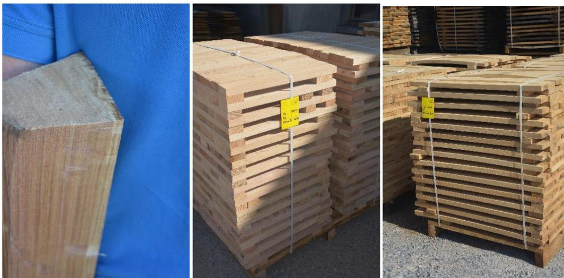
Il faut 5m<sup>3</sup> de bois pour faire 1m<sup>3</sup> de merrains. L'épaisseur est variable : 22, 27, 30, 32 et 40 mm. La largeur varie de 6 cm minimum à 12 cm maximum. L'aubier et le cœur sont enlevés, les rayons médullaires doivent être respectés au sciage. Un angle droit est fait (photo de gauche), un doublon (deux merrains) sera fait dans ce morceau. Au centre, une pile pour faire des fonds, à droites pour les corps des tonneaux.
