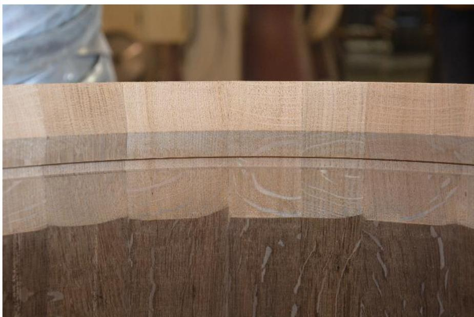
*Vue de la machine qui sert à évider les bords de la barrique afin d'y placer le fond et le couvercle. A droite, aspect de l'intérieur du tonneau après la chauffe. La rainure sera remplie de pâte à pain avant l'installation du fond pour assurer l'étanchéité.*
