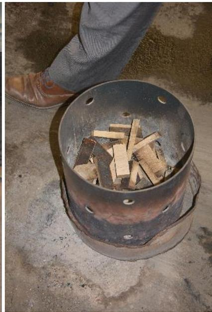
*L'assemblage obtenu est placé sous une étuve pour être cintré. Vient ensuite l'opération de la chauffe. Le braséro de chauffe est alimenté par les « rebus » de sciage.*
