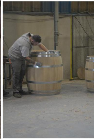
*Un fond prêt à être installé et un petit ponçage manuel pour la finition, du grand art ! Avant, il y a eu un test d'étanchéité avec de l'eau chaude sous pression à 0,5bar.*
