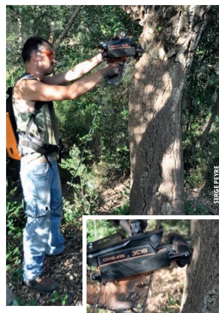
Découpe des fentes verticales le long du tronc
