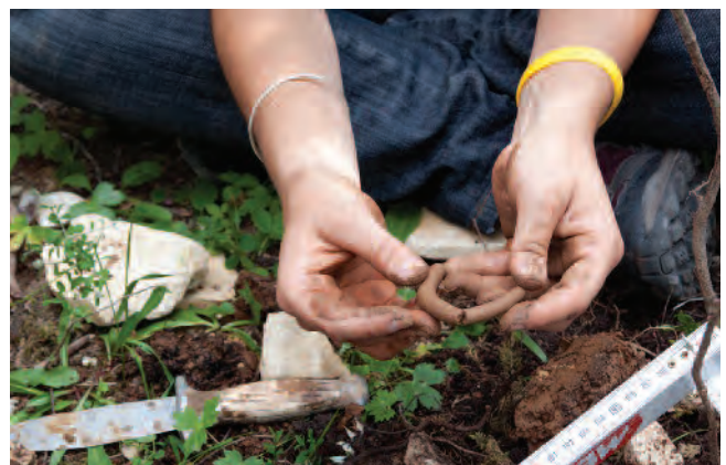
Test du boudin pour évaluer la teneur en argile
