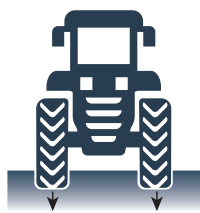
Sol humide = tassement Les forces du sol sont insuffisantes
